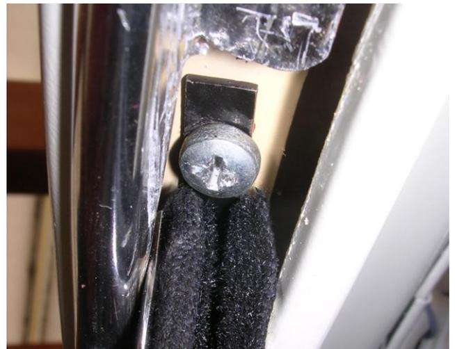
Diese Schraube mit der Zange anbeißen lassen und rein drehen aber noch nicht anziehen.
