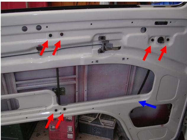
Der Gummischlauch wird durch das Loch in der Strebe gesteckt (Blauer Pfeil im Bild oben).
