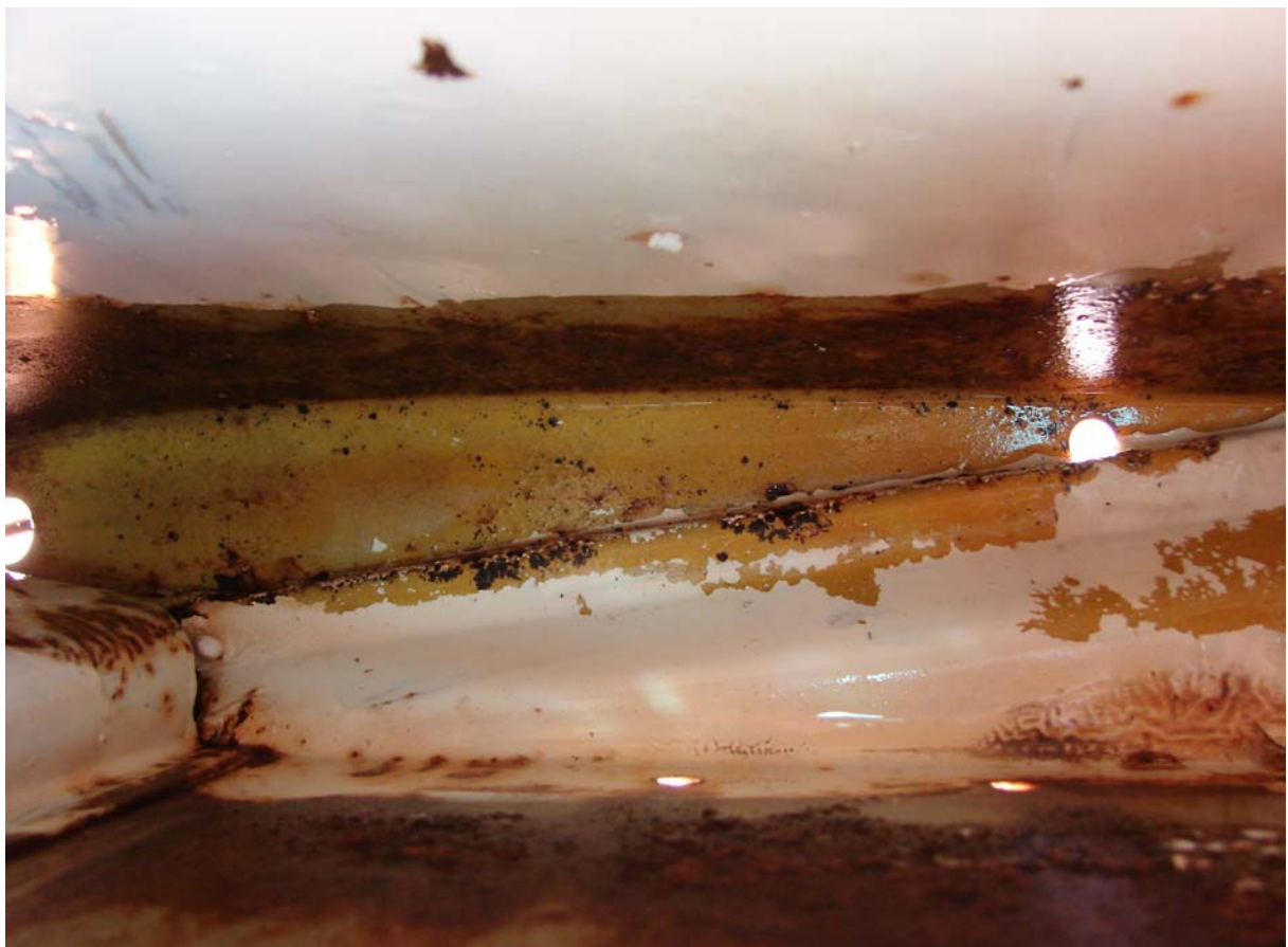
Der Blick ins Innere der Tür nach unten. Hier ist das braune Zeug Rost und kein Dreck.
