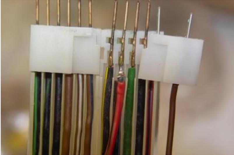
Wie man sieht, darf man nicht zu nah mit dem Kabel an den Stecker heran, sonst geht das Gehäuse nicht mehr zu. 2-3 mm Platz lassen.
