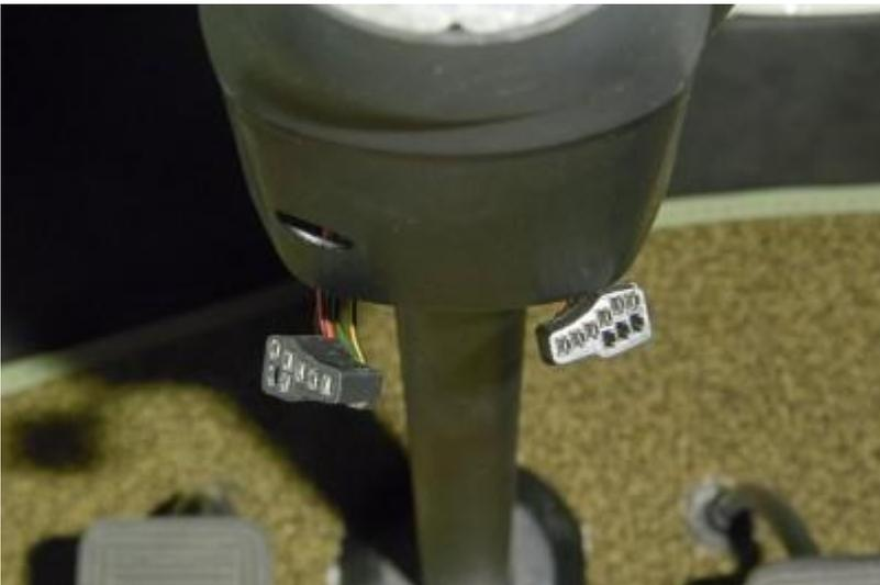
Dann muss der Hupenknopf ab. Getrennt wird zwischen Metallring und Knopf. Keinesfalls unter den Metallring hebeln.
