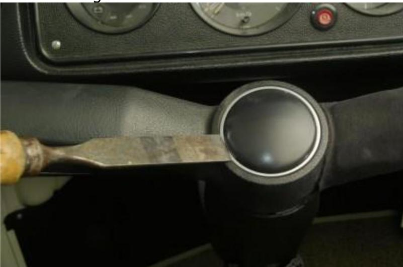
Darunter kommt ein Stecker (Flachsteckhülse) zum Vorschein - bitte abstöpseln. Dann die Zentralmutter mit einem 24er Steckschlüssel abschrauben. Bevor Ihr das Lenkrad abzieht, sollte die Stellung markiert werden, das erleichtert den Zusammenbau.
