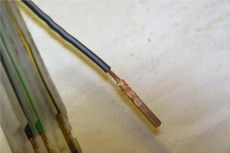
Dort muss das freie Ende des neuen rot-schwarzen Kabels angelötet werden. Also den Bereich verzinnen und das neue Kabel positionieren. Z.B. so:
