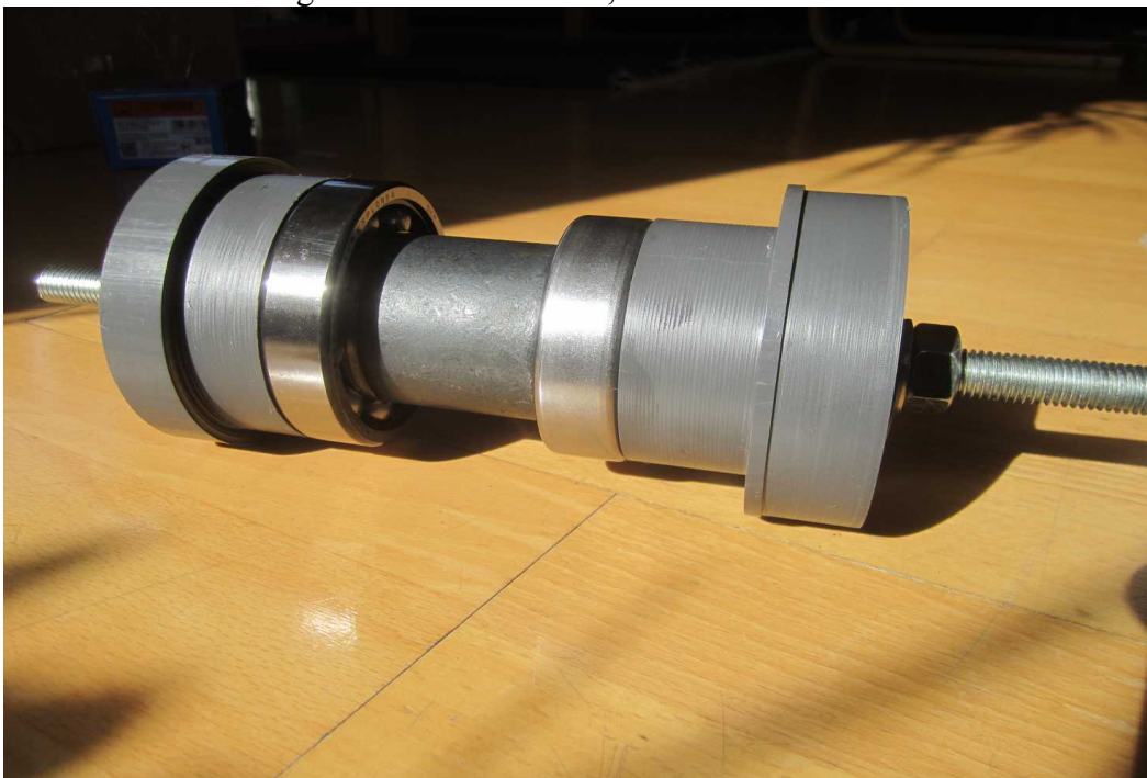
Bild 6: Die Einbauhilfe mit Aufgesteckten Lagern und Distanzhülse
