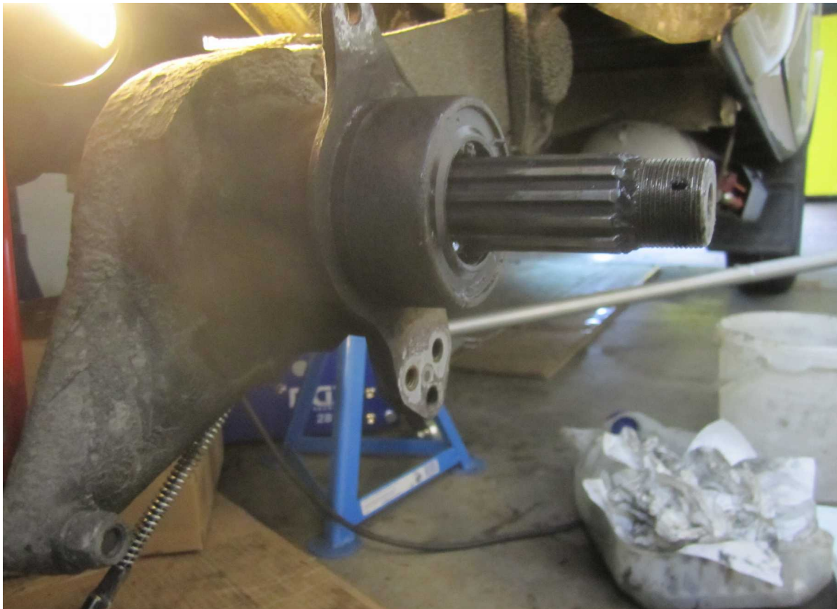
Bild 11: Mit dem Gummihammer eingetriebene Hinterradwelle
