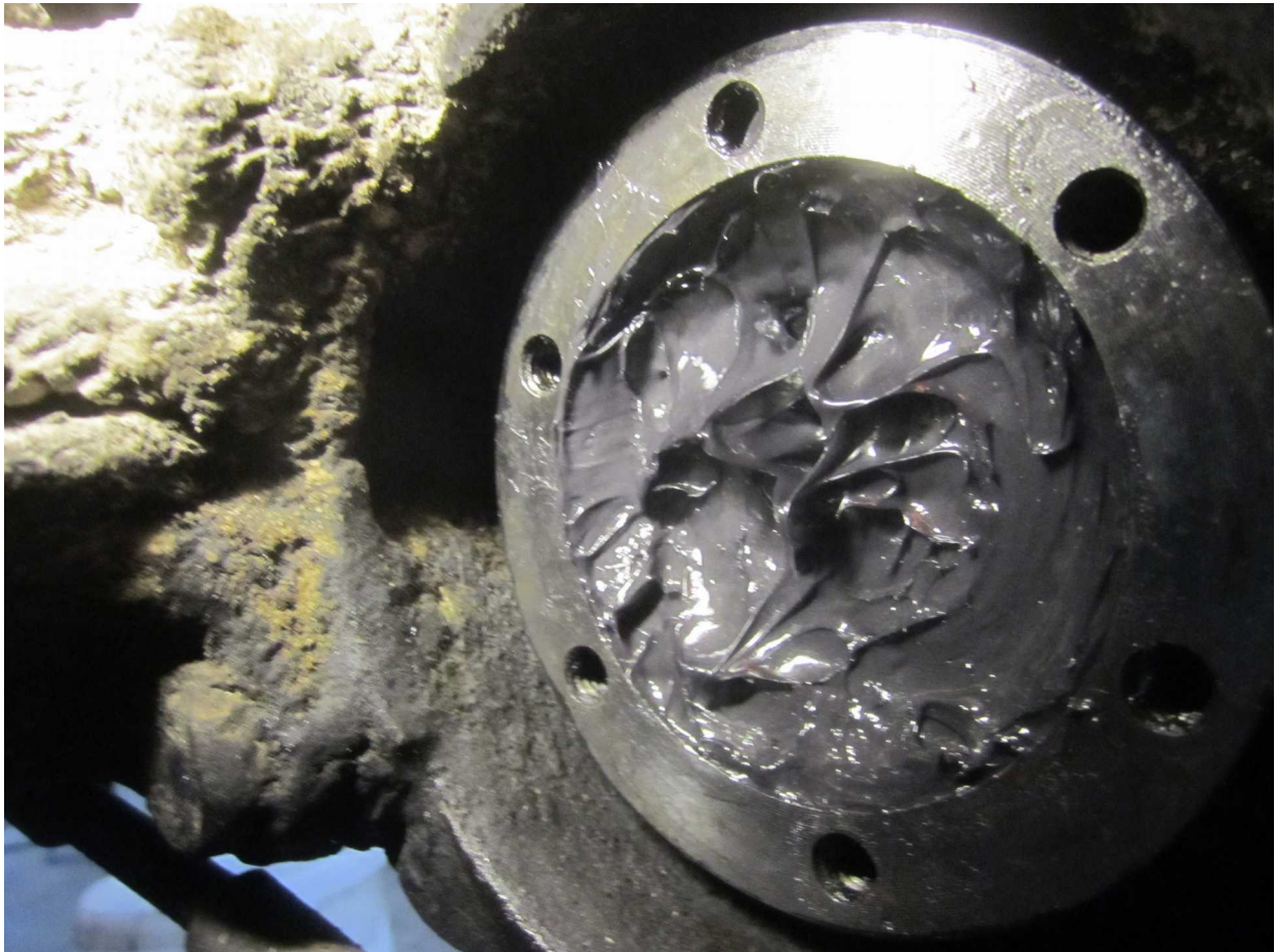
Bild 12: Mit frischem Fett aufgefüllte Hinterradwelle
