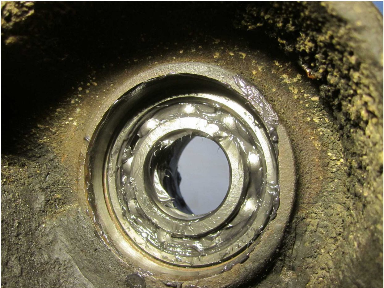
Bild 7: Inneres Radlager mit Fett befüllt
