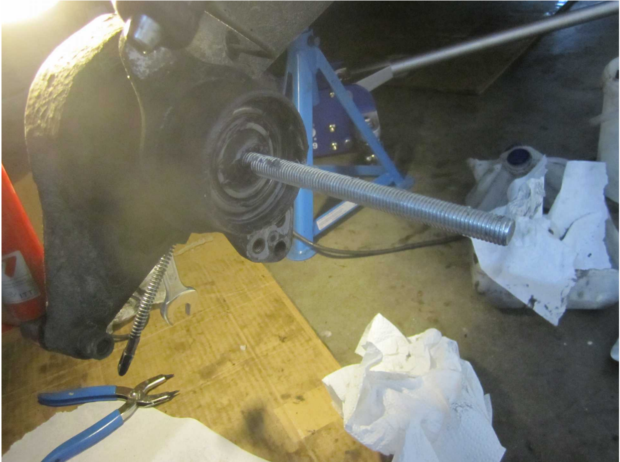
Bild 8: Das frisch eingepresste Wälzlager mit teilen der Einpresshilfe
