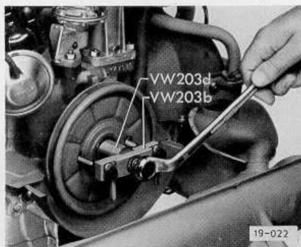
Abb. 4 Riemenscheibe ausbauen
