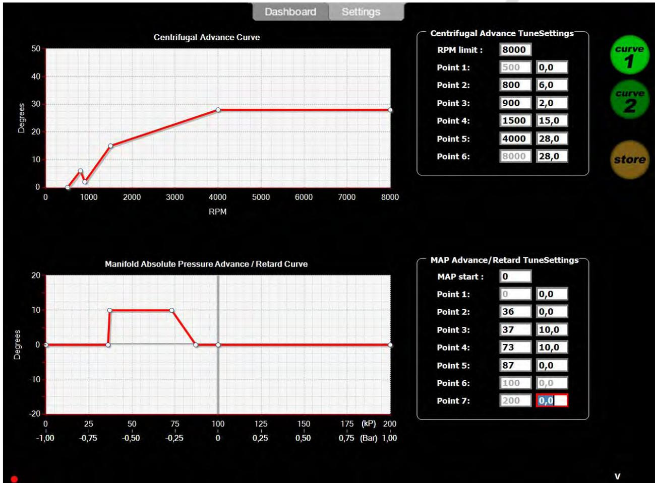
Die Drehzahl tendiert dazu, sich im „Tal“ der Zündkurve bei 900 U/min zu stabilisieren.
