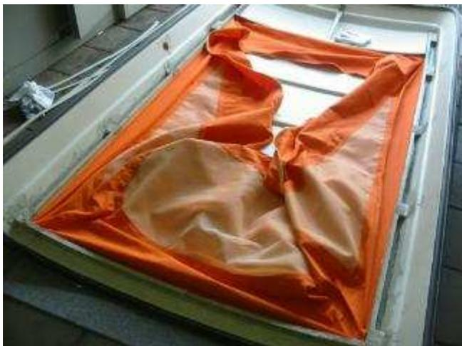
**D**as neue Zelt legen wir jetzt nicht genau im Einklang mit der Deckung der Naht. Beginnend mit dem Kopfteil. Wir befestigen zuerst die Ecken.
