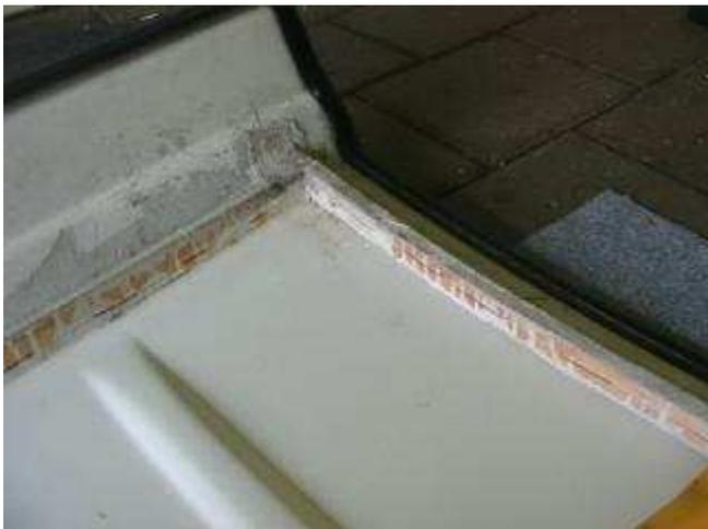
Die Klammern aus den leisten lösen und dort wo sie befestigt waren, markieren wir die Position des Stoffes mit Filzstift auf dem Dach (siehe die roten Linien auf dem Bild).
