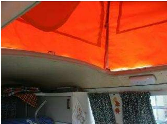
**W**ir strecken das Tuch zu Beginn mit kurzen geraden Aluminium-Streifen. Wir haben die Mitte des Stoffes gemessen (von Naht zu Naht) und markiert. In der Mitte des Daches wird eine Markierung gesetzt. Nach einer sorgfältigen Suche nach der ersten Schraube und deren Loch befestigen wir das Zelt. Der Rest der Bohrungen wird dann leicht gefunden werden.
