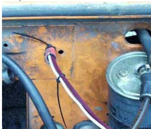
Die Kabel werden möglichst günstig entlang des Unterbodens verlegt. Wer ganz auf Nummer sicher gehen will, kann an beiden Enden des roten Kabels fliegende Sicherungen anbringen
